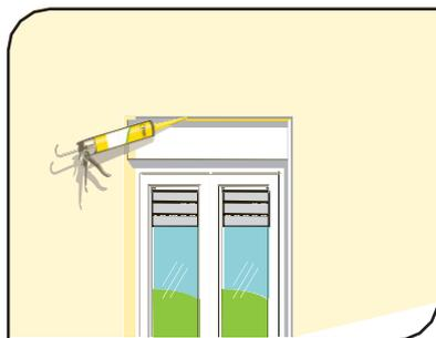
**Alcasil NP** Sigillante neutro monocomponente con elasticità permanente ed ottima aderenza su tutti i materiali da costruzione (calcestruzzo, mattone, legno, acciaio, alluminio, diversi tipi di plastica, calcestruzzo espanso, ceramica, cartongesso, vetro, klinker, metallo, porcellana, polistirolo, smalto, ecc).
