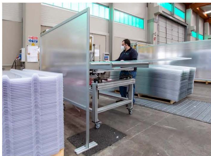
Barriera da terra per postazione di lavoro.
