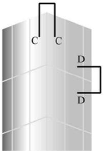
**Figura 3A:** Vista verticale. Esempio di vetrata strutturale a quattro lati (installazione in fabbrica).
