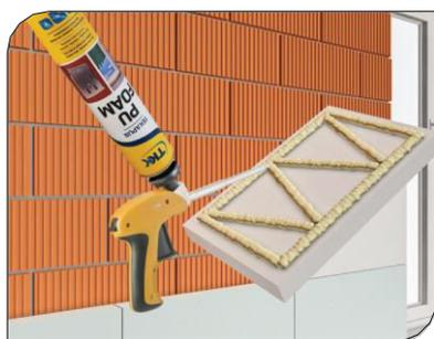
**Tekapur Insulation Adhesive** è un adesivo poliuretano monocomponente a bassa espansione utilizzato per il montaggio di materiali isolanti con l'ausilio di una pistola per schiuma. Indurisce con l'umidità dell'aria.
